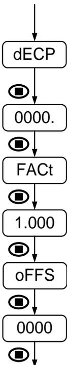
Le premier paramètre est la sélection de la position du point décimal. Après l’indication "**dECP**", le point décimal intermittent est par défaut à droite ce qui indique un affichage sans point décimal. Utiliser la touche **SHIFT** pour le déplacer à la position souhaitée.
