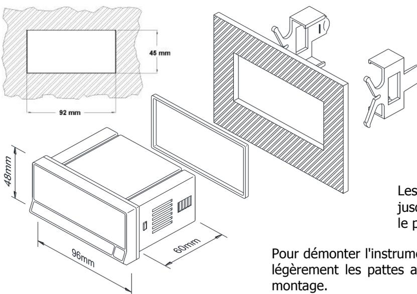
Pour installer l'instrument en panneau, ouvrir un orifice dans celui-ci de 92x45mm de dimensions puis introduire l'instrument par la face avant du panneau en plaçant le joint d'étanchéité entre les deux.
