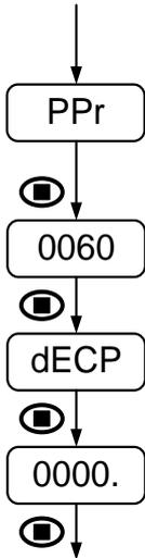
Si le mode tachymètre rpm (**tACH**) a été sélectionné dans la configuration de l'entrée, la routine de configuration de l'affichage correspond à ce diagramme. La touche **ENTER** est utilisée pour valider le paramètre et avancer dans le menu.
