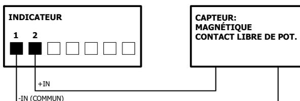
**Raccordement de capteur NAMUR**
