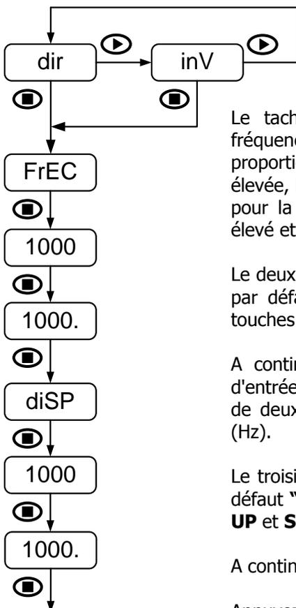
Si le mode tachymètre rate (**rAtE**) a été sélectionné dans la configuration de l'entrée, la routine de configuration de l'affichage correspond au diagramme de gauche. La touche **ENTER** est utilisée pour avancer dans le menu.
