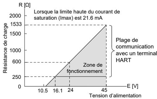
Note 1 : La résistance de charge varie suivant la dérive de la limite du courant de saturation [I max]
